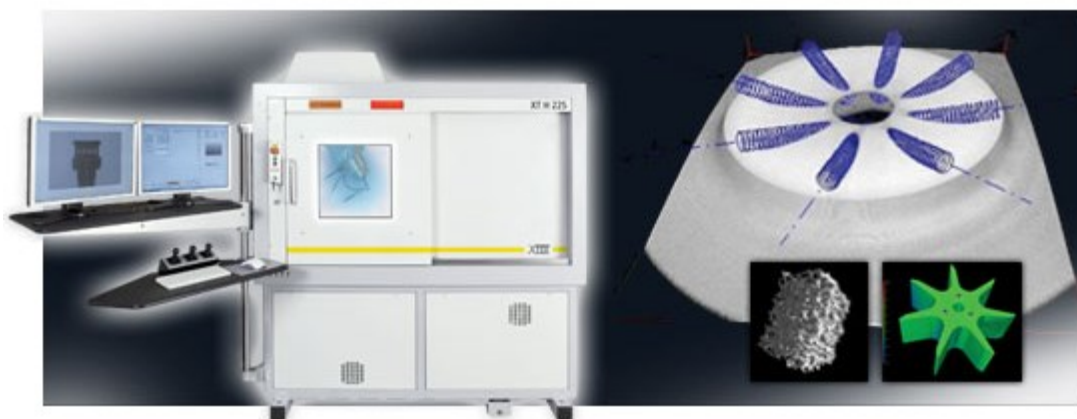
Obr. 111 Kombinovaný rentgenový skener CT & X-Ray firmy Metris, typ XT H 225 a příklady skenovaných objektů
