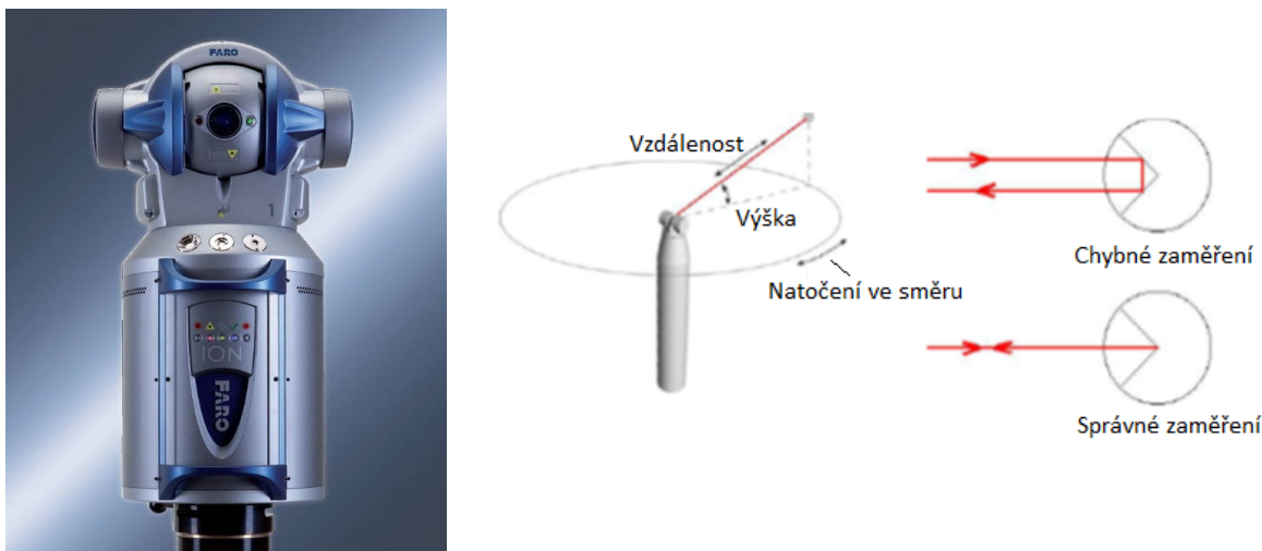
Obr. 107 Laser tracker a jeho schéma určení pozice reflektoru
