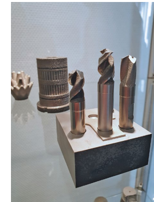
Fräswerkzeuge, Formkerne, Stempel oder Matrizen die mittels 3D-Druck (Quelle: Kolibri Metals GmbH)
