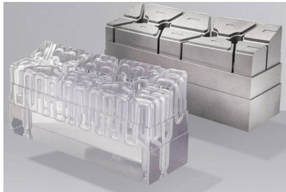
Spritzguss-Formeinsatz mit kontur-naher Kühlung (www.fkm.net)
