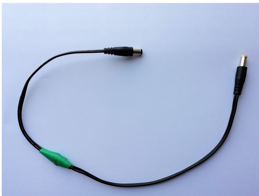
Obrázek č.2: PoE splitter redukce (konvertor) 5,5/2,1 mm na 5,5/2,5 mm (M-M) vlastní výroby.
