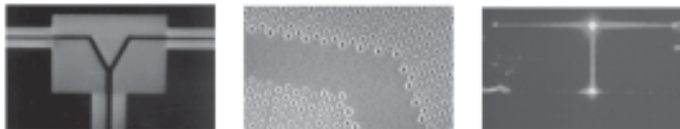
Obrázek: Příklad fotonické součástky - dělič svazku; vlevo je připravená struktura, uprostřed je detail PBG vlnovodu s ohybem, vpravo ověření funkce součástky.
