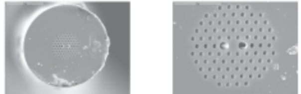
Obrázek: Čelo mikrostrukturního optického vlákna; vlevo obrázek získaný skanovacím elektronickým mikroskopem, vpravo je detail pláště vlákna s otvory a jádra bez otvorů.
