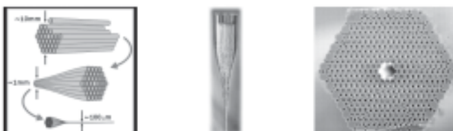
Obrázek: Fotonické krystalové vlákno; vlevo schéma výroby, uprostřed preforma pro tažení, vpravo průřez vytáženým vláknem.
