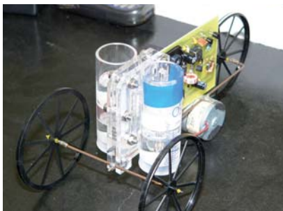
Soutěžní stroj Hydrogen rider – poháněný vodíkovým palivovým článkem
