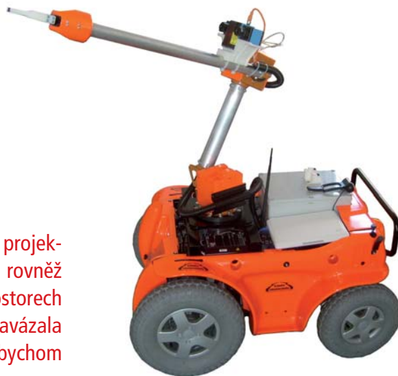
Obr. 1 - Mobilní robot Hercules autor: Ing. Tomáš Kot
